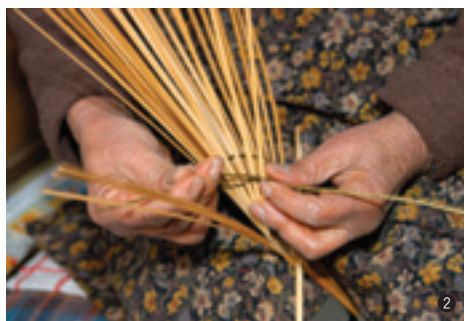
① 刃入れの後、骨しぼりという技法で竹を割っていく环さん(茨城県郷土工芸技術伝承者) ② 骨は、い草で編んでいく ③ 横山大観揮毫による雪村の碑
