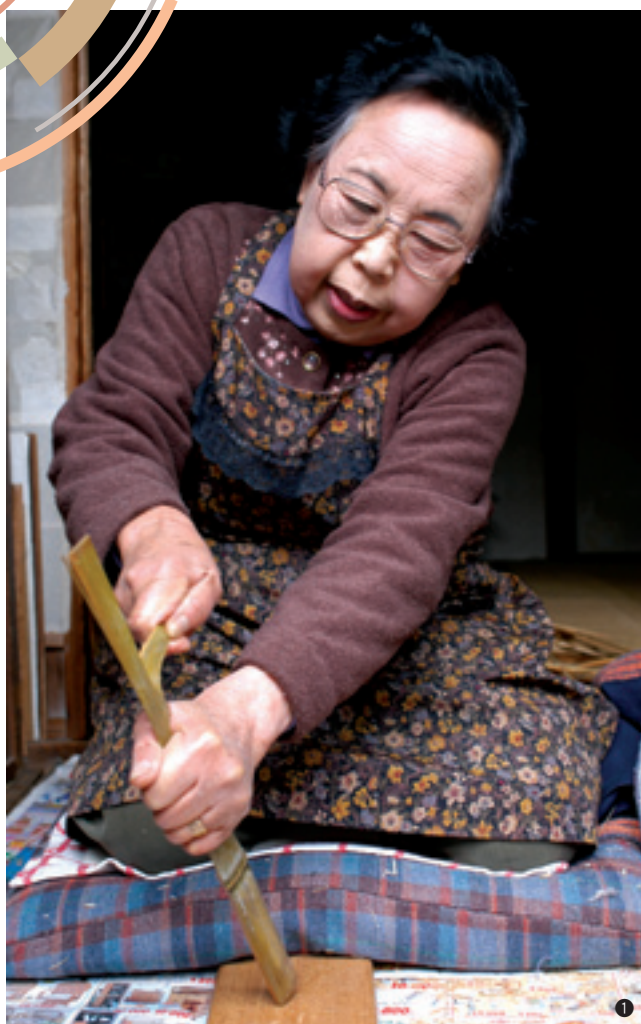
① 刃入れの後、骨しぼりという技法で竹を割っていく环さん(茨城県郷土工芸技術伝承者) ② 骨は、い草で編んでいく ③ 横山大観揮毫による雪村の碑
